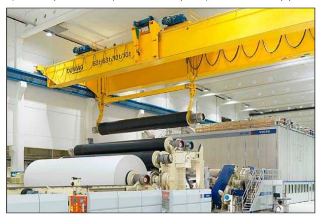
On ne s'intéresse qu'à l'élévation d'un rouleau. La mise en mouvement est assurée par un motoréducteur qui se compose d'un <u>moteur</u> alimenté par un courant triphasé et d'un <u>réducteur</u> à engrenages.
